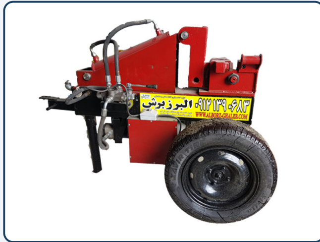
نمای پشتی دستگاه: الکتروموتور 3 اسب بخار، پمپ هیدرولیک 16 لیتری و چرخ‌های صنعتی توپر
