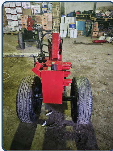
نمای فوقانی دستگاه و سیستم فک برش و خمکاری میلگرد - تیغ آلیاژی K600 BOHLER
