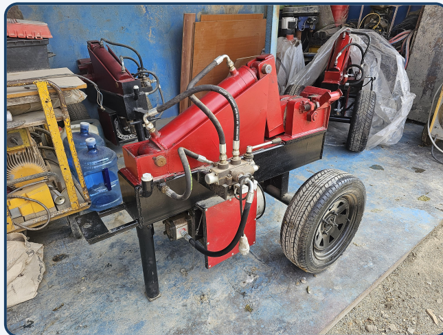
نمای جانبی دستگاه خم و برش میلگرد دو چرخ 32 - شاسی مستحکم و چک هیدرولیک
